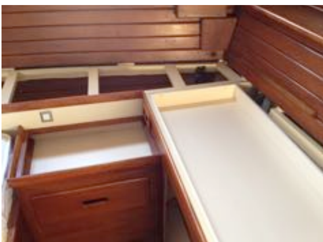
Les anti-roulis sont refaits à l'identique et l'ensemble des éléments en teck sont teintés pour s'harmoniser avec les tiroirs d'origine et le reste du mobilier.
