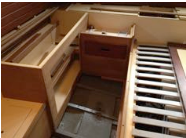
Tout le mobilier est construit selon les techniques du chantier de l'époque : contreplaqué teck, panneaux de porte, tiroir et anti roulis en teck massif.
